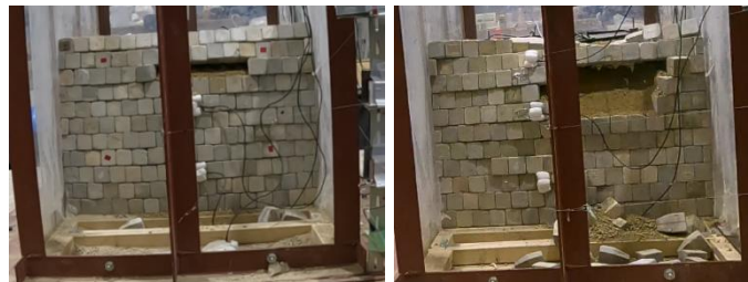
(a) 鉄筋挿入工法
